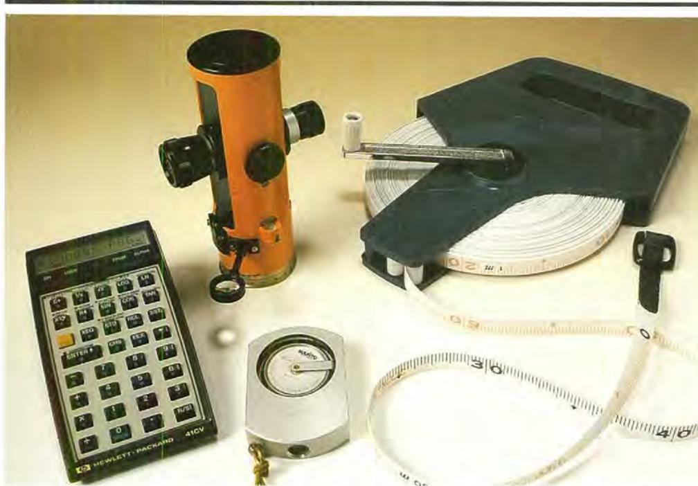
Matériel pour repérer le centre de la placette d'échantillonnage sur le terrain: boussole à lunette, clisimètre, chevillière et calculatrice de poche.
