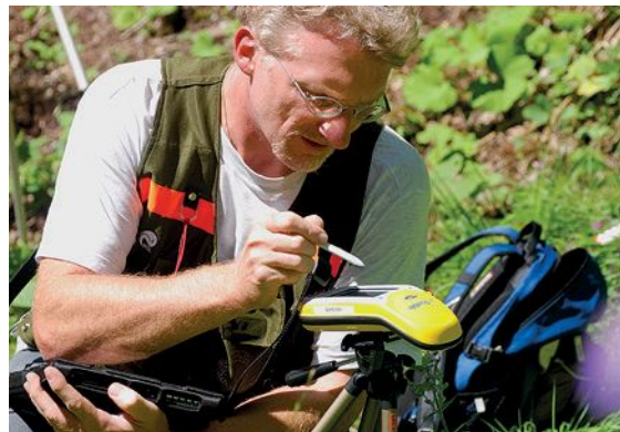
Das Zentrum jeder Probefläche wird mit Geländepunkten und einem GPS vermessen.
